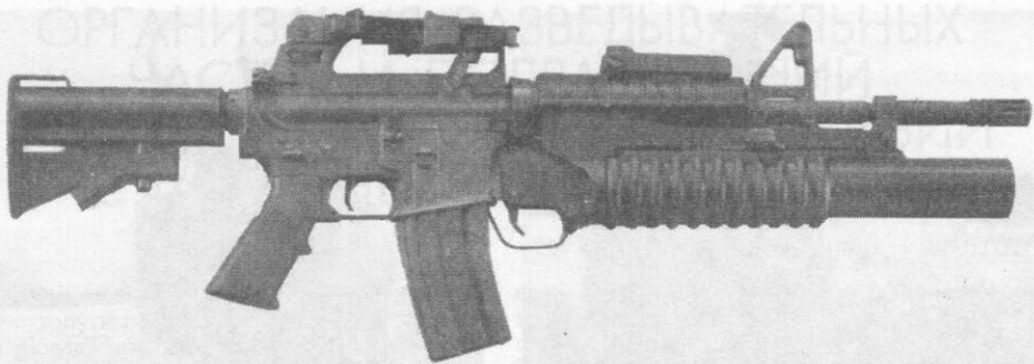
Рис. 1. Карабин М4 для ССО с 40-мм подствольным гранатометом М203 (общий вид)
